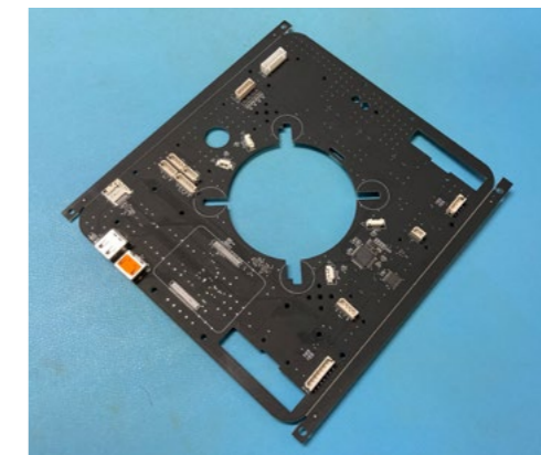
▲ Integrated PCB Chassis: PCB Serving as the Main Structural Frame (Apr 2021) Integriertes PCB-Chassis: Leiterplatte als Hauptstrukturrahmen (Apr. 2021)
