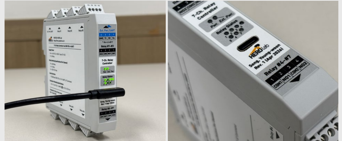
▲ 7-Channel USB CDC Relay Controller “Vythos” Module, Handmade Using a Milling Machine (Apr 2026) 7-Kanal-USB-CDC-Relaissteuerungsmodul „Vythos“, manuell mit einer Fräsmaschine gefertigt (Apr. 2026)
